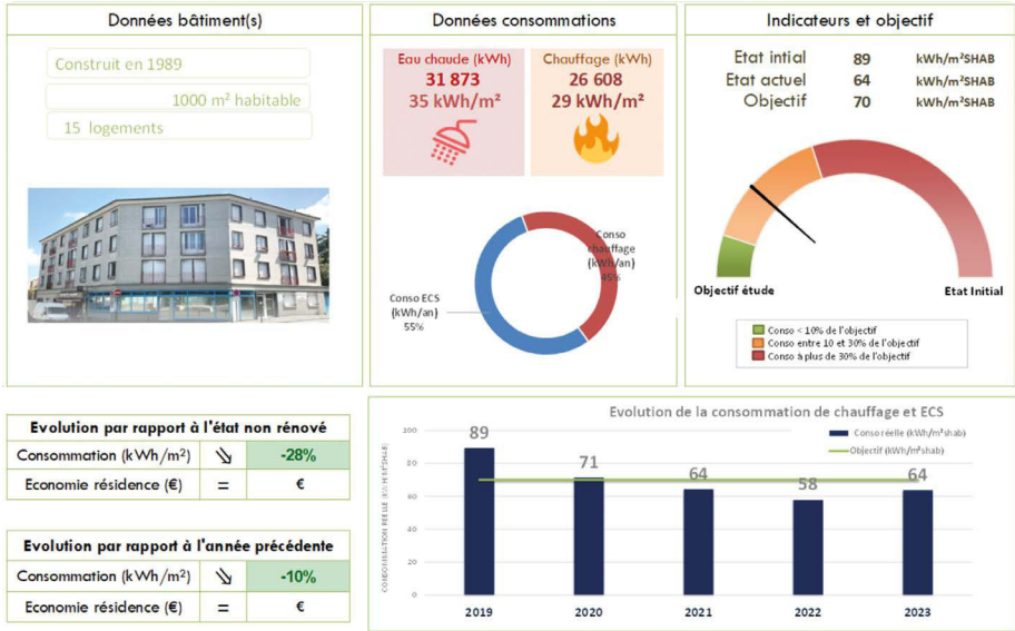
Résidence Les Tilleuls - Tableau de bord énergétique 2023 Exemple de tableau de bord possible grâce au suivi des factures
